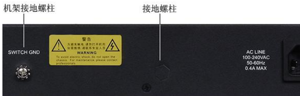
图2-1 RG-S1824GT-ES-V2系列交换机接地示意图
